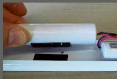
Dans le domaine de l'éclairage des bandes Velcro adaptées sont utilisées, de sorte que lors de panne, la batterie peut être remplacée à tout moment, à l'aide des lumières de secours.
