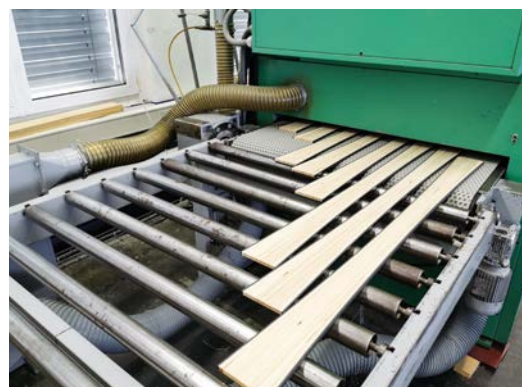
Ces longues pièces sont ensuite insérées dans la ponceuse à bande large et rectifiées ...
