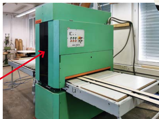
Ces longues pièces sont ensuite insérées dans la ponceuse à bande large et rectifiées ...
