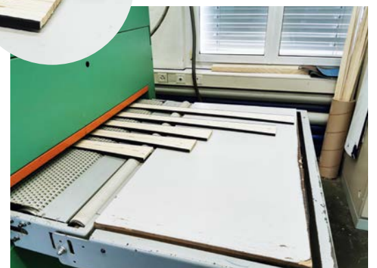
Ces longues pièces sont ensuite insérées dans la ponceuse à bande large et rectifiées ...
