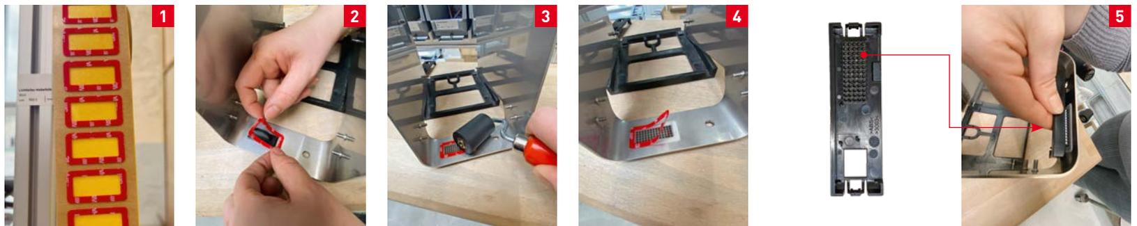
L'enveloppe en acier chromé est nettoyée avec de l'alcool isopropylique avant le collage. La pièce prédécoupée autocollante double face (1) est appliquée sur le boîtier intérieur (2) et pressée avec une roulette (3). Le protecteur est retiré (4) pour que le composant mâle puisse être fixé et collé (5).
