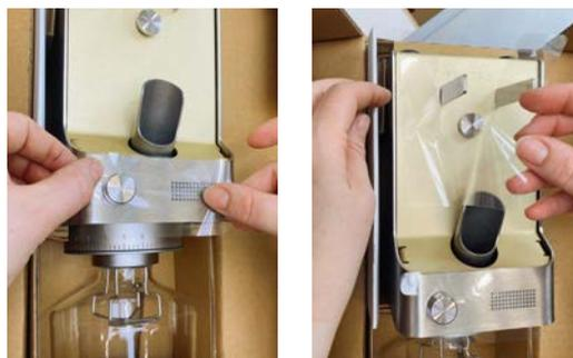
Avant l'emballage, un film de protection de surfaces est appliqué à différents endroits. Celui-ci est prédécoupé avec précision, à la forme et à la taille requises. Il permet de s'assurer que les appareils arrivent chez le client sans aucune rayure. Le film peut être retiré sans laisser de traces avant l'utilisation.
