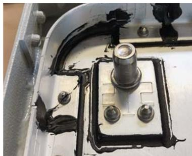
Nach dem Auftrag bildet der Dichtstoff an der Oberfläche innerhalb von rund 4 Stunden eine dünne Haut. Diese verhindert, dass der Dichtstoff bei der Reinigung vor der Pulverbeschichtung ausgewaschen wird.
