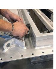
Mit der 3M Cubitron II Fiberscheibe, Korn 40 werden die Ecken geschliffen.
