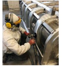
Wer schleift, schützt sich: Schutzhelm, Gehörschutz und Handschuhe von 3M Mit den Klingspor-Fiberscheiben werden die Schweissnähte und Flächen
