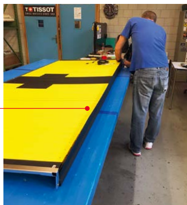
Primer 3M Scotch-Weld 9348 wird auf PVC aufgetragen.
