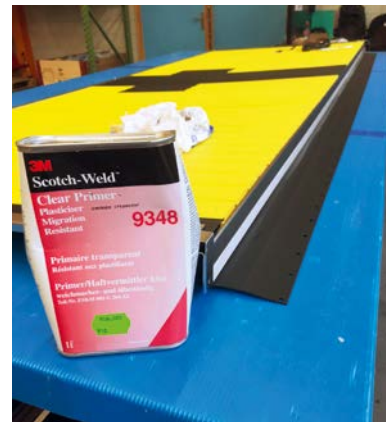
Primer 3M Scotch-Weld 9348 wird auf PVC aufgetragen.
