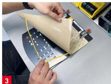
**3** Das Schutzpapier wird vom schmalen Formteil-Rahmen (bis 3 mm) abgezogen.
