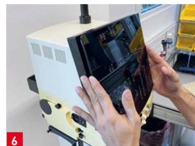
**6** Die Displayabdeckung wird auf dem Operationsgerät positioniert und angedrückt.
