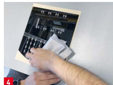
**4** Das Display wird auf den offenen Klebstoff des Formteils fixiert und angedrückt.
