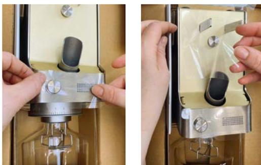
Vor dem Verpacken wird an verschiedenen Stellen eine Oberflächenschutzfolie aufgebracht. Diese ist exakt vorgestanz, in der benötigten Form und Grösse. Sie sorgt dafür, dass die Geräte ohne Kratzer beim Kunden ankommen. Die Folie kann vor Gebrauch rückstandsfrei entfernt werden.
