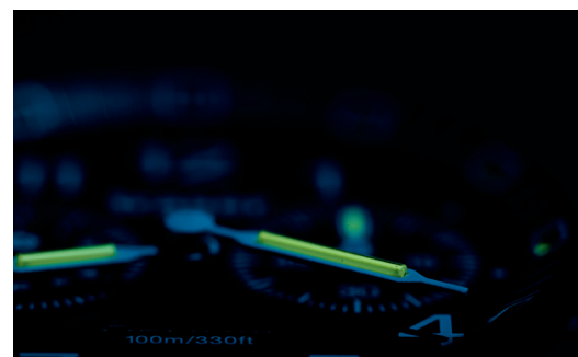
trigalight wird auf den ausgesparten klebenden Stellen auf dem Zifferblatt und Zeiger aufgeklebt
