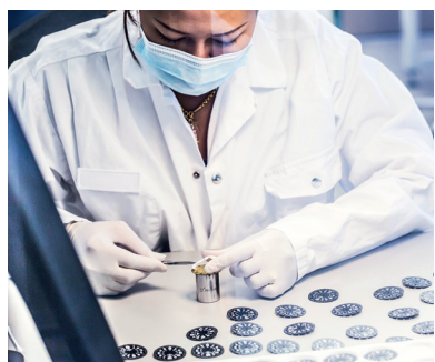
Uhrmacherin appliziert einseitig klebendes Stanzteil auf der Rückseite des Zifferblatts
