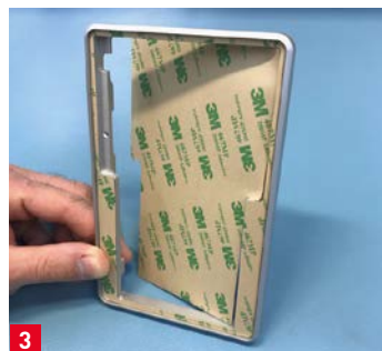
3 Das Innenteil wird erst jetzt herausgedrückt, da es beim Positionieren aus Stabilitätsgründen noch benötigt wurde.
