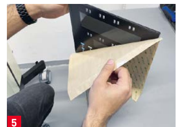
5 Das Trägerpapier wird abgezogen.
