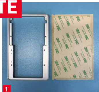
1 Der Aluminiumrahmen wird vor der Verklebung mit IBZ-Isopropylalkohol gereinigt.
