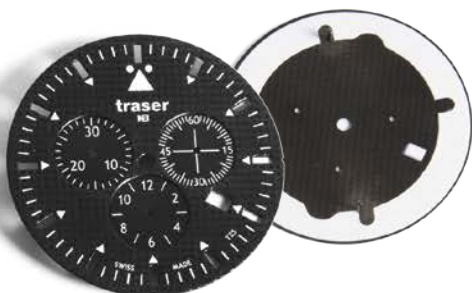
Uhrmacherin appliziert einseitig klebendes Stanzteil auf der Rückseite des Zifferblatts
