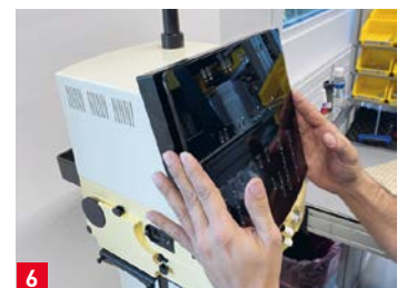
6 Die Displayabdeckung wird auf dem Operationsgerät positioniert und angedrückt.
