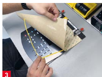
3 Das Schutzpapier wird vom schmalen Formteil-Rahmen (bis 3 mm) abgezogen.
