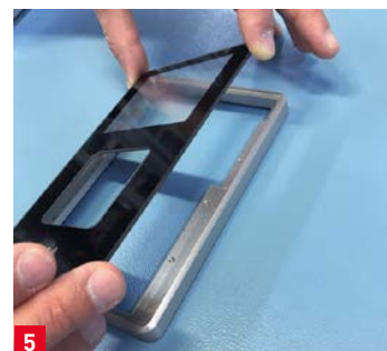
5 Das Glas wird auf dem IBZ-Formstanzteil bzw. Alurahmen fixiert und ange-drückt.
