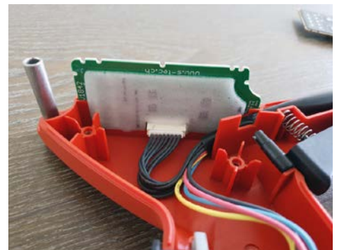
Formteil wird auf die Leiterplatte appliziert, um die Elektronik vor Feuchtigkeit zu schützen
