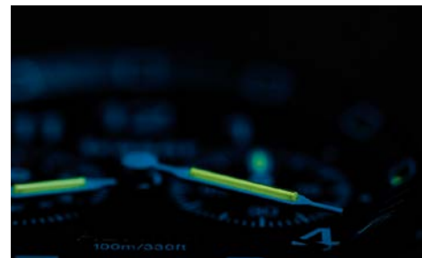
trigalight wird auf den ausgesparten klebenden Stellen auf dem Zifferblatt und Zeigern aufgeklebt
