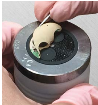
Schutzpapier wird von doppelseitigem Klebeband abgezogen
