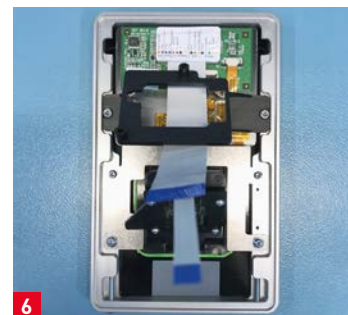
6 Elektronik wird auf der Rückseite eingebaut.
