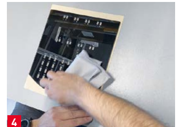
4 Das Display wird auf den offenen Klebstoff des Formteils fixiert und angedrückt.
