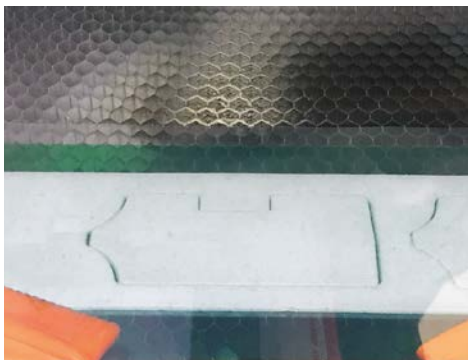
Einseitiges Extrem-Dichtband wird auf Rollen lasergeschnitten
