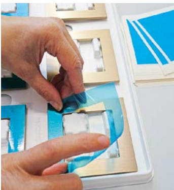
Oberflächenschutzfolie wird appliziert.
