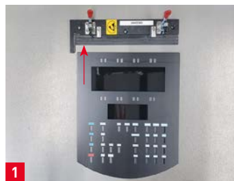
1 Die Abdeckung wird vor der Verklebung mit IBZ Isopropylalkohol gereinigt und bündig an die Positionshilfe gelegt.
