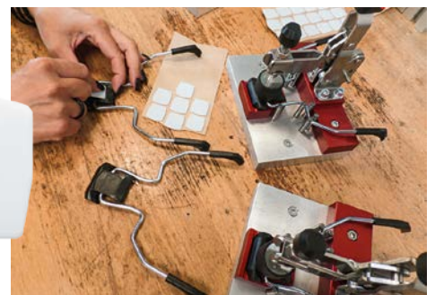
Eine nichtklebende Teflonfolie wurde mit einem speziellen doppelseitigen Klebeband beschichtet und auf die gewünschte Form gestanzt.
