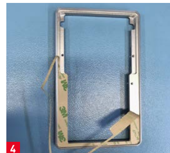
4 Das Schutzpapier wird abgezogen.
