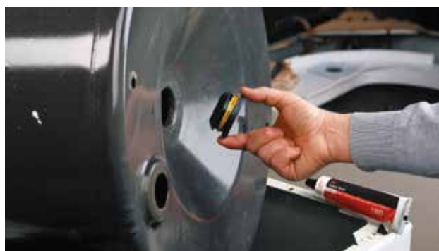
Pour la réparation de machines à laver, la colle haute performance à base de néoprène pour caoutchouc et joint 3M™ 1300 adhère avec une résistance immédiate élevée et scelle le joint torique de l'anneau dans la cuve extérieure.
